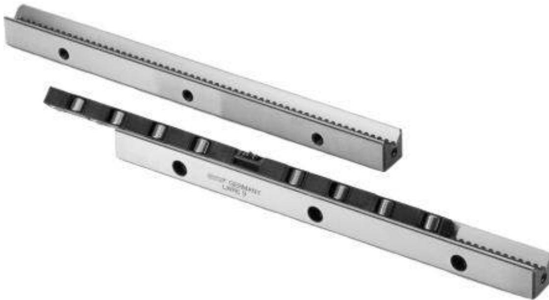
So mancher Anwender kennt das „Käfigwandern“ bei konventionellen Präzisionsschienenführungen. Hohe Beschleunigungen, ungleiche Vorspannungen oder Lastverteilungen sind die Ursache dieses Phänomens. Eine Neuentwicklung der SKF Linearsysteme GmbH eliminiert mit einem raffinierten „Anti-Creeping-System“, kurz ACS genannt, dieses Herauswandern des Käfigs aus seiner Sollposition.
