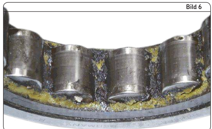
Durch Stromdurchgang verursachte Schwarzfärbung des Schmierfetts
