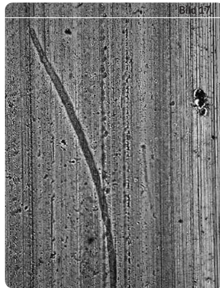
Laufbahneindrückungen durch überrollte Fremdteilchen
