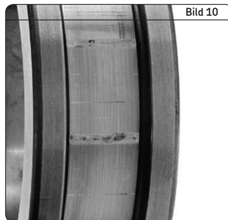
Riffelbildung in einem Zylinderrollenlager infolge von Schwingungen im Stillstand
