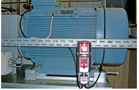
(links oben und unten) Motoren und Lüfter Durch den Einsatz von perma Schmiersystemen müssen kombinierte Motoren und Lüfter nicht unplanmäßig gestoppt werden. Die Wechselintervalle können stattdessen in die Revisionsphase gelegt werden.
