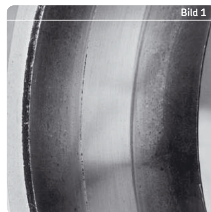
Außenring eines Pendelrollenlagers, dessen Laufbahn durch schmirgelnde Teilchen verschlissen wurde. Verschlissene und nicht verschlissene Bereiche sind deutlich zu unterscheiden.
