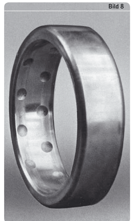
Außenring eines Pendelkugellagers, durch Erschütterung im Stillstand beschädigt. Die Stellung der Ringe zueinander blieb während des Stillstands unverändert.
