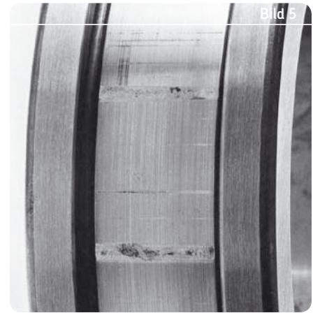
Verschleiß durch Schwingungen am Innenring eines Zylinderrollenlagers. Der Schaden ist bei Stillstand des Lagers entstanden. Die deutlich schwächeren Rillen – gut zu unterscheiden von den ausgeprägten Mulden mit korrodiertem Grund – deuten darauf hin, dass sich der Ring für kurze Zeitschnitte in Umfangsrichtung weiterbewegt hat.
