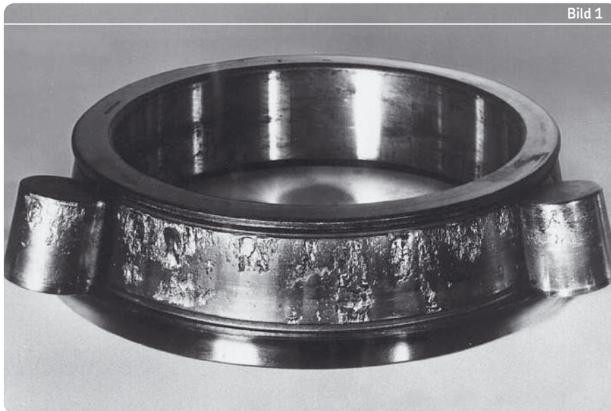
Schälungen an Innenring und Rollen eines Kegelrollenlagers. Schadensursachen waren zu hohe Belastungen und unzureichende Schmierung.
