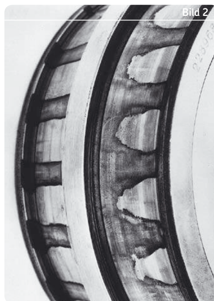
Starke Korrosion infolge Wassereinwirkung (Wasserätzung) auf dem Innenring eines Pendelrollenlagers.
