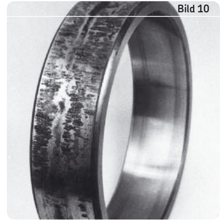
Anschmierungen an der Mantelfläche eines Pendelrollenlager-Außenrings. Von der Gehäusebohrung wurde Werkstoff auf den Lagerring übertragen.
