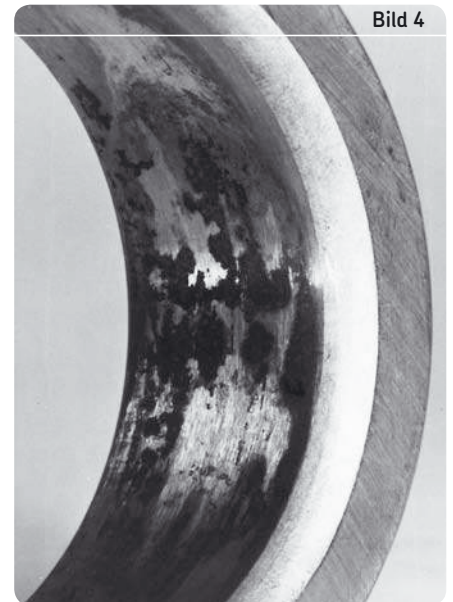
Starker Passungsrost in der Bohrung eines Pendelkugellagers.
