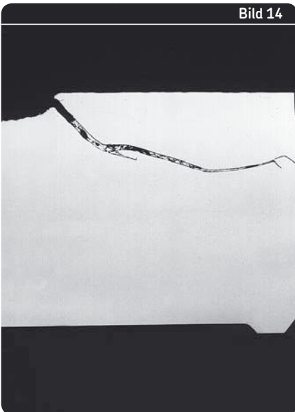
Schnitt durch eine Rolle. Deutlich erkennbar ist der Verlauf des Ermüdungsrisses unter der Oberfläche. Die Schälung hat sich auf diese Weise entwickelt.
