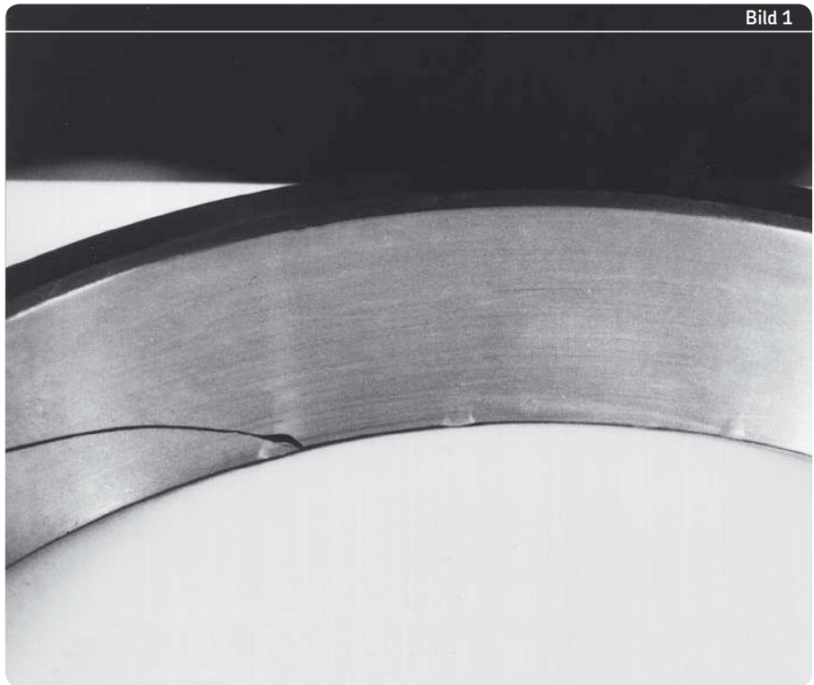
Gerissener Außenring eines Pendelkugellagers. Die Eindrückungen am unteren Laufbahnrand wurden durch unsachgemäße Behandlung verursacht. Der Riss geht von einer dieser Eindrückungen aus.
