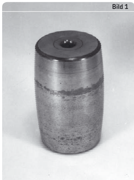
Oberflächenzerrüttung, die als Band über den gesamten Umfang einer Rolle eines Pendelrollenlagers verläuft.
