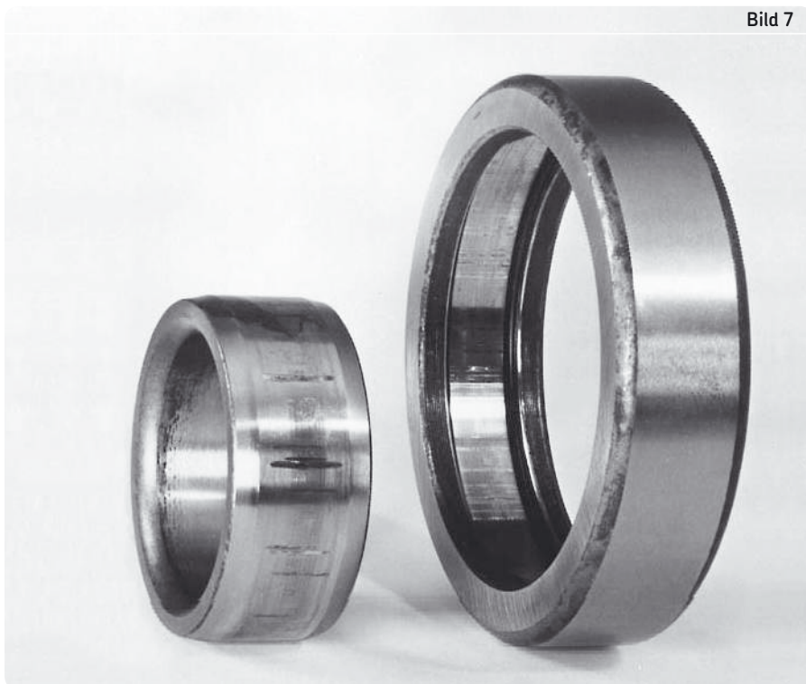
Innen- und Außenring eines Zylinderrollenlagers, das Schwingungen ausgesetzt war.
