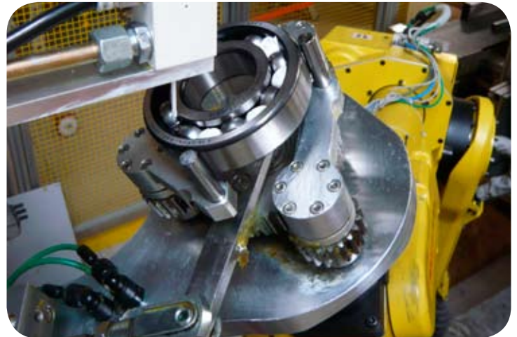
Kundenspezifische Lagermodifikation: Sonderschmierstoff für abgedichtete Lager
