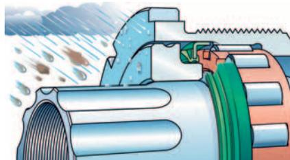
Das Tretlager ist üblicherweise am tiefsten Punkt im Rahmen eingesetzt und daher die Sammelstelle für all das Wasser, das in den Rahmen eindringt. Ist die Hülse des Tretlagers nicht aus einem Stück gefertigt, kann das Wasser leicht in das Lager eindringen und es zerstören. SKF Tretlagereinheiten bestehen deshalb aus einer einteiligen Hülse und bieten so einen effektiven Schutz vor diesem lästigen Problem.
