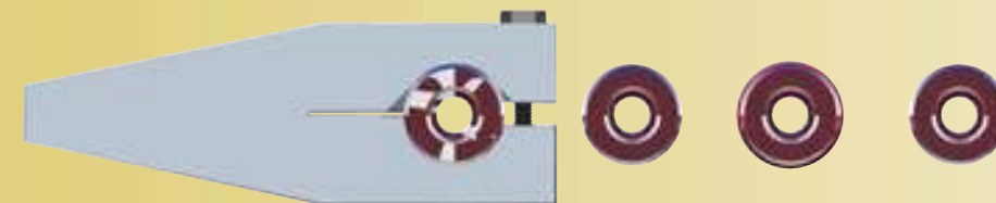
Wiederaufbau der Wellenoberfläche für eine Klemmverbindung
