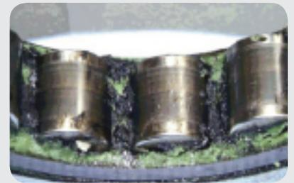
Verschmutzter Schmierstoff durch Funkenerosion
