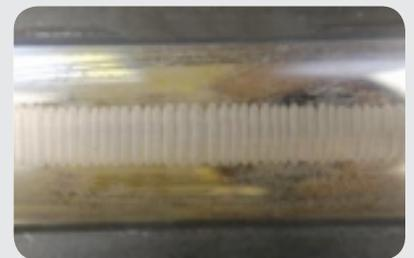
Typische Riffelung bei Funkenerosion in Wälzlagern
