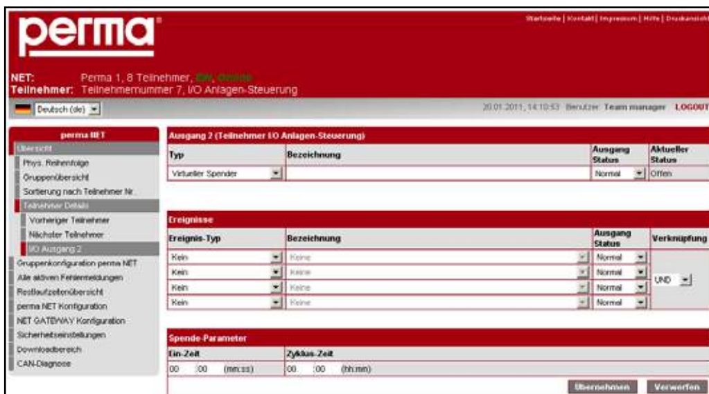
Abb. 41: Konfiguration Ausgang perma NET I/O als virtueller Spender
