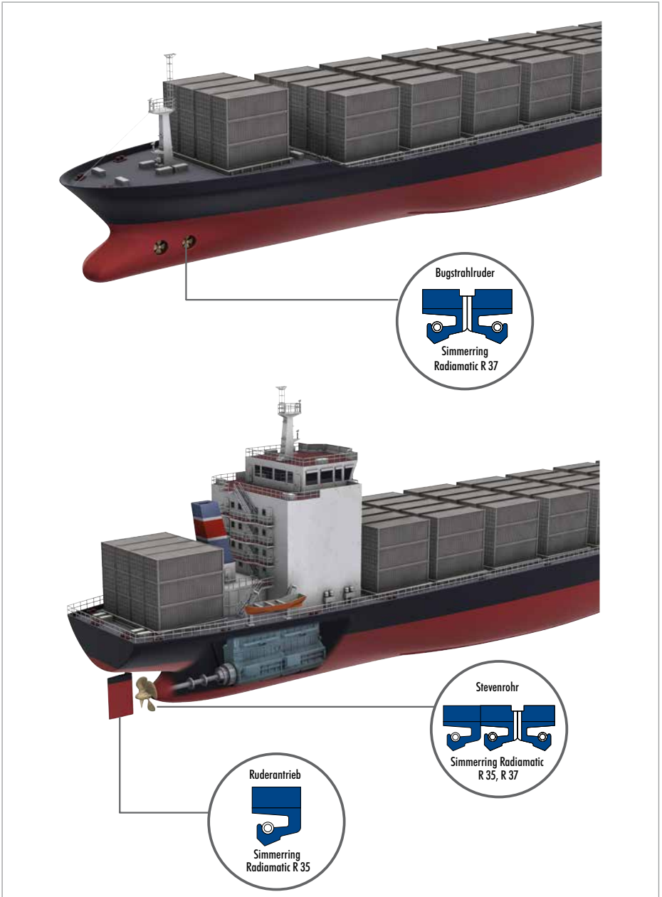
Abb. 5 Simmerringe in Unterwasseranwendungen der Schiffstechnik
