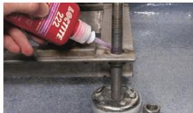
Mit normalen Handwerkzeugen demontierbar, ideal für Stellschrauben, Kalibrierschrauben, Messgeräte, Manometer; für Gewinde bis M 80.
