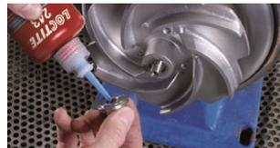
Mit normalen Handwerkzeugen aber schwieriger demontierbar, ideal für Befestigungsschrauben an Werkzeugmaschinen, Pressen, Pumpen, Kompressoren und Getrieben; für Gewinde bis M 80.
