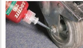
Mit normalen Handwerkzeugen nur sehr schwer demontierbar, eventuelles Erwärmen erforderlich. Für Schrauben in montierten Teilen, an Mess- und Regelgeräten, Vergaserschrauben.
