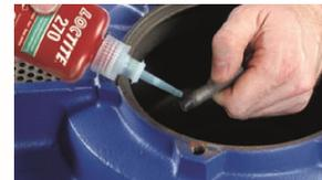
Mit normalen Handwerkzeugen nur sehr schwer demontierbar, eventuelles Erwärmen erforderlich. Für Schrauben in Anlagen, die nicht regelmäßig demontiert werden müssen – Schwermaschinen, Motor- und Pumpenlager, Stiftschrauben; für Gewinde bis M 80.
