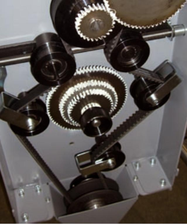
Zahnriemen kommen in der Textilindustrie in verschiedenen Ausführungen und Profilen zum Einsatz. Ob kleine Zahnriemen aus Chloropren als Spindeltrieb in Texturiermaschinen oder Hochleistungs-Zahnriemen in großen Profilen als Hauptantriebe bis hin zu Zahnriemen aus Polyurethan, z.B. Meterware verschleißt, in Rundstrickmaschinen. Das Sortiment ist sehr vielfältig, und die Anwendungen sind nahezu unbegrenzt.
